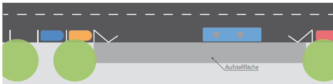
Abbildung 3: Haltestelle am Fahrbahnrand mit Längsparkstreifen
