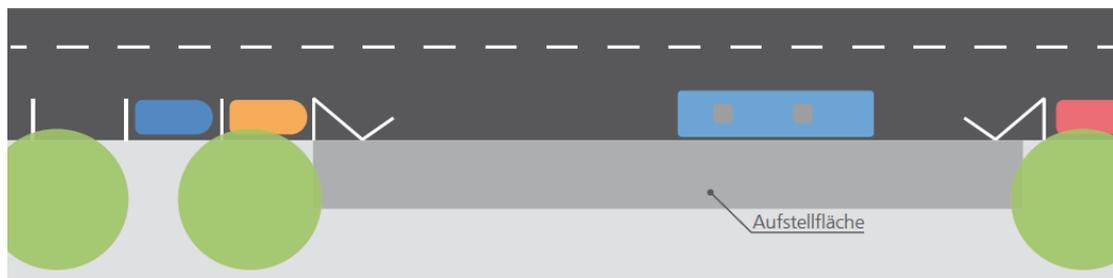
Abbildung 3: Haltestelle am Fahrbahnrand mit Längsparkstreifen
